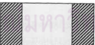
รูปที่ 4.19 สัดส่วนพื้นที่เปิดของพื้นตะแกรง 50% ของพื้นที่หน้าตัดทั้งหมด(มองด้านบน)
