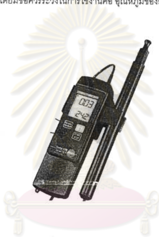
รูปที่ 4.2 ภาพถ่ายของเครื่องวัดความเร็วลมสำหรับวัดความเร็วลมภายในห้อง
