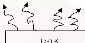
รูปที่ 2.3 การถ่ายเทความร้อนโดยการแผ่รังสี
