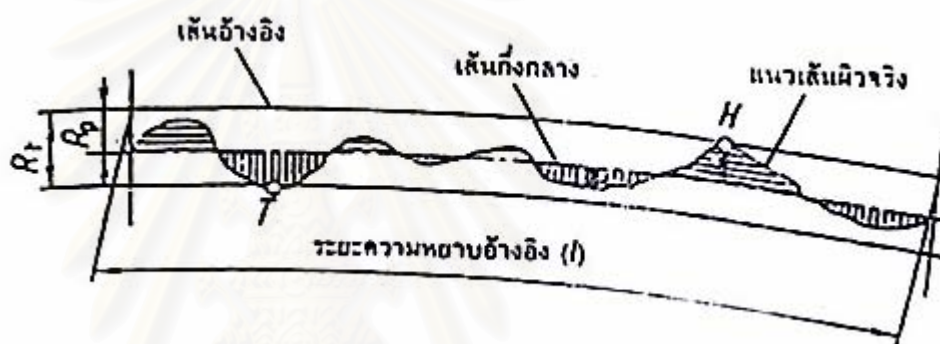
รูปที่ 2.4 แสดงการวัดค่าความหยาบผิว R_t
