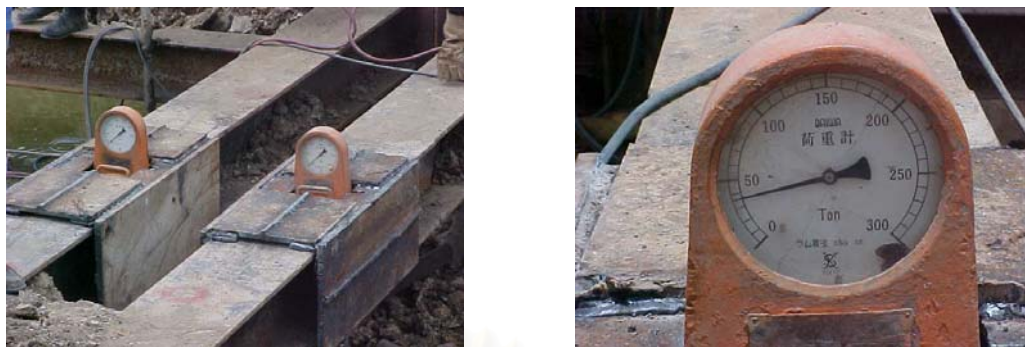
รูปที่ 3.19 ลักษณะของ Load Cell ที่ใช้ในโครงการ
