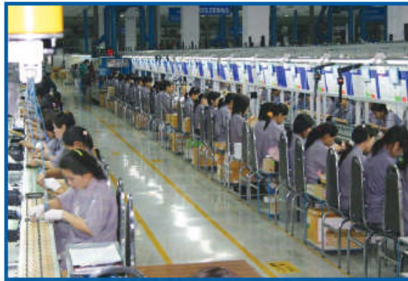
รูปที่ 4.2 การผลิตขั้นตอน Hand insertion
