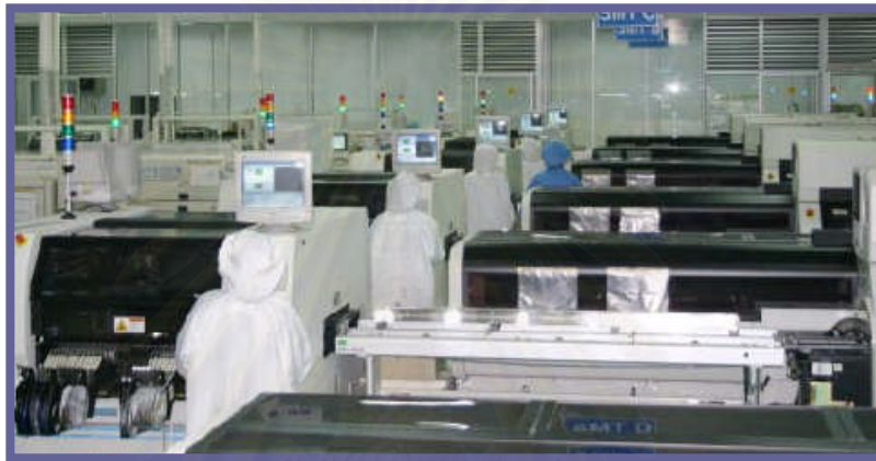
รูปที่ 4.1 การผลิตขั้นตอน Surface Mounted Device (SMD)
