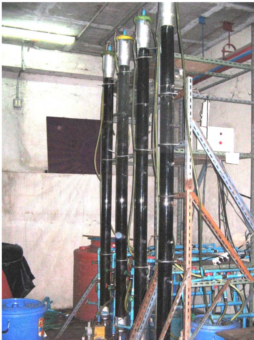
รูปที่ 3.5 ลักษณะการติดตั้งระบบโอโซนปีได่ตักเจริญวิศวกรรม
