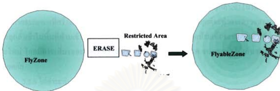
รูปที่ 3.17 แสดง “FlyableZone” ที่ได้จากการนำเอา “Flyzone” มาลบออกด้วยพื้นที่ห้ามเข้าที่ถูกสร้างแนวกันชน หรือ “Restricted Area”
