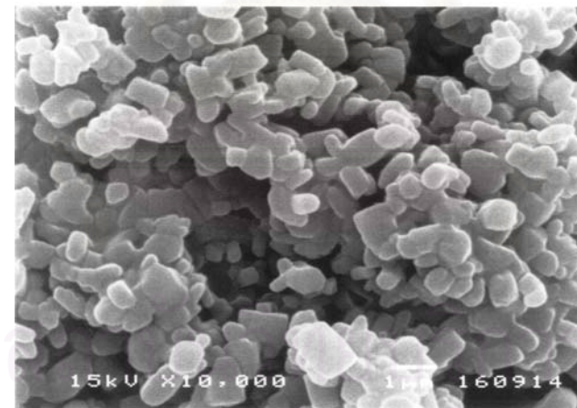
รูปที่ 4.13 อัตราส่วนโดยน้ำหนักของน้ำต่ออะลูมิเนียมที่มีต่อโครงสร้างผลึกที่ได้จากการวิเคราะห์ด้วยกล้องจุลทรรศน์อิเล็กตรอนขนาดขยาย 10,000 เท่า สำหรับสารประกอบอะลูมิเนียมที่ผ่านการไฮโดรไลซิส โดยใช้อัตราส่วนโดยน้ำหนักของน้ำต่ออะลูมิเนียม ต่างๆ กัน (ก) 10 ต่อ 1 (ข) 30 ต่อ 1 (ค) 50 ต่อ 1 ที่เวลา 15 นาที อุณหภูมิ 30 องศาเซลเซียส จำนวนรอบ 100 รอบต่อนาที
