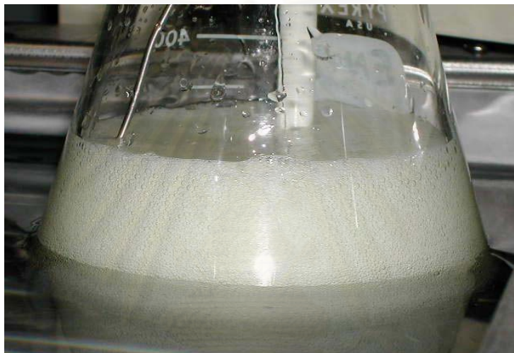
รูปที่ 4.9 ขั้นตอนการไฮโดรไลซิสสารประกอบอัลคอกไซด์ในน้ำมันแร่ขาวโดยใช้ น้ำ ซึ่งในปฏิกิริยาจะมีฟองก๊าซเกิดขึ้นเล็กน้อยขึ้นกับจำนวนรอบในการปั่นกววน
