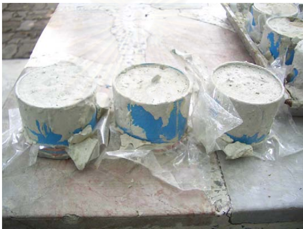
รูปที่ 3.4 ตัวอย่างของเสียที่ผ่านการทำก้อนแข็ง
