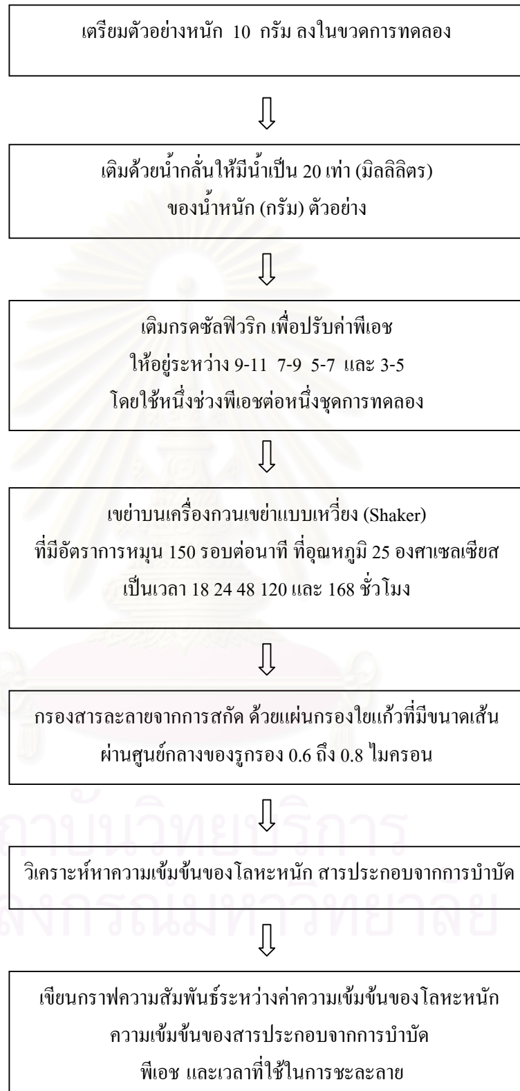
รูปที่ 3.8 แผนผังแสดงขั้นตอนการทดลองการชะละลายโดยกรดซัลฟิวริก
