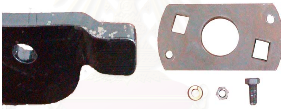
รูปที่ 2.11 ลักษณะของด้ามใบมีดและหน้าแปลนสำหรับติดใบมีดแบบผสม
