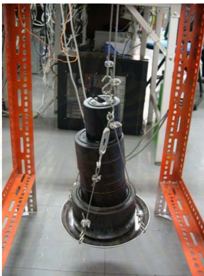
รูปที่ 5.5 การใส่ตุ้มน้ำหนักบนถาดรองรับ
