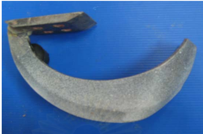
รูปที่ 5.17 การฟันซี่ที่ใบมีดทดสอบ
