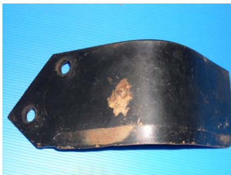
รูปที่ 5.14 ปุ่มบนใบมีดสำหรับสร้างรอยการเคลื่อนที่
