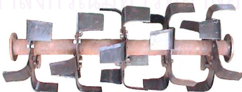
รูปที่ 2.14 การจัดเรียงใบมีดชนิดตัวแอลบนเพลลาใบมีด
