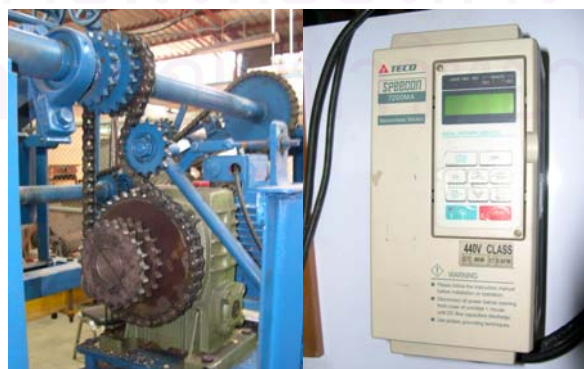
รูปที่ 4.7 ชุดเฟืองทดรอบและอินเวอร์เตอร์ที่ใช้ควบคุม
