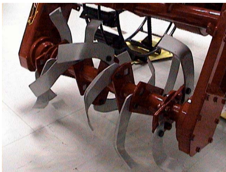
รูปที่ 2.17 การจัดเรียงใบมีดแบบผสมบนเพลลาใบมีด
