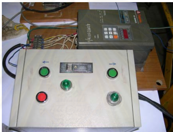
รูปที่ 4.6 ชุดควบคุมการเคลื่อนที่ของกระบะทราย
