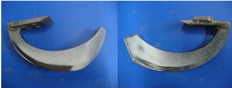
รูปที่ 7.19 รอยการเสียดสีที่เกิดจากการพรวนด้วยใบมีดชนิดตัวซี
