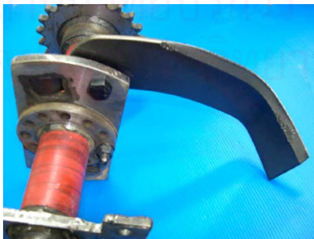
รูปที่ 2.12 ลักษณะการติดใบมีดแบบผสมบนหน้าแปลน
