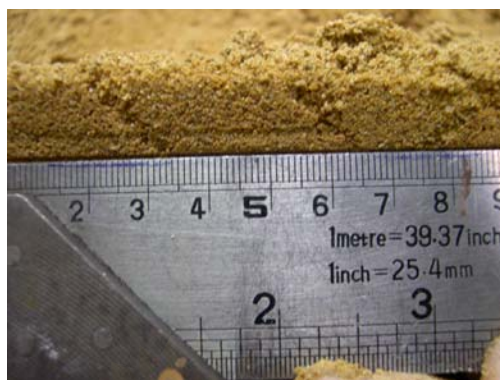
รูปที่ 5.16 การวัดระดับความลึกในการพรวน
