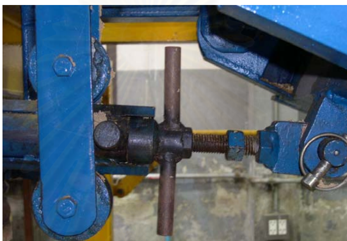
รูปที่ 4.8 กลไกในการปรับระดับความลึกในการพรวน
