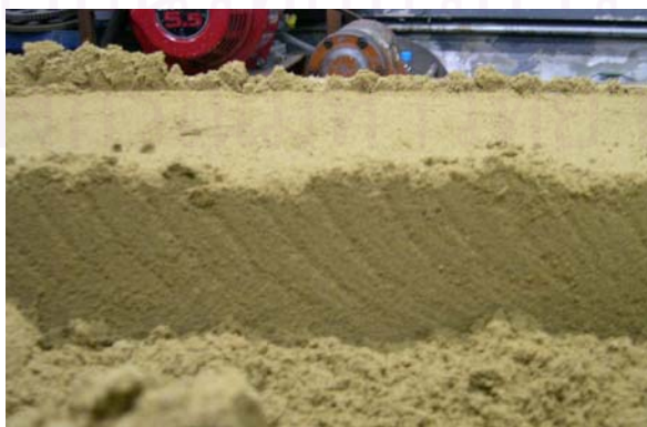
รูปที่ 5.15 รอยการตัดทรายที่เกิดขึ้น
