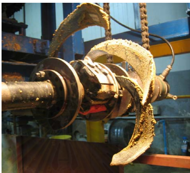
รูปที่ 5.10 การจัดเรียงใบมีดรูปแบบต่างๆ ของใบมีดชนิดตัวซี
