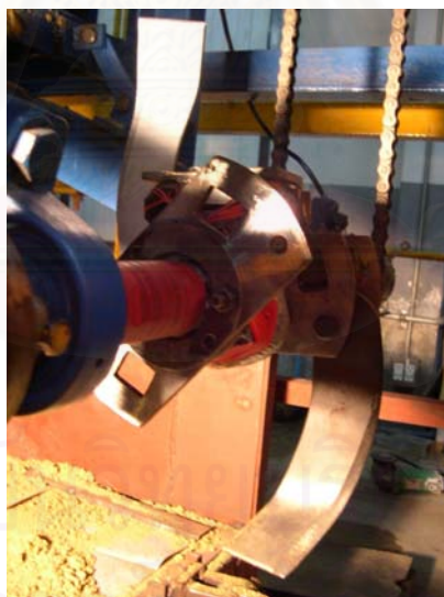
รูปที่ 5.6 การติดไวมีดเพิ่ม เพื่อให้สภาวะการพรวนของไวมีดเต็มใบกับไวมีดที่ตัดส่วนปลายออก มีลักษณะเหมือนกัน
