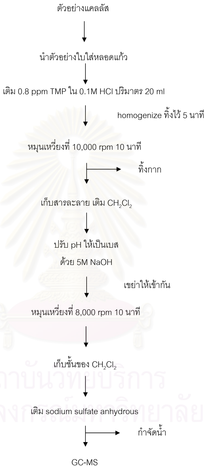
รูปที่ 3.2 ขั้นตอนการสกัด 2AP จากตัวอย่างแคลลัสของข้าวและเตยด้วยตัวทำละลาย
