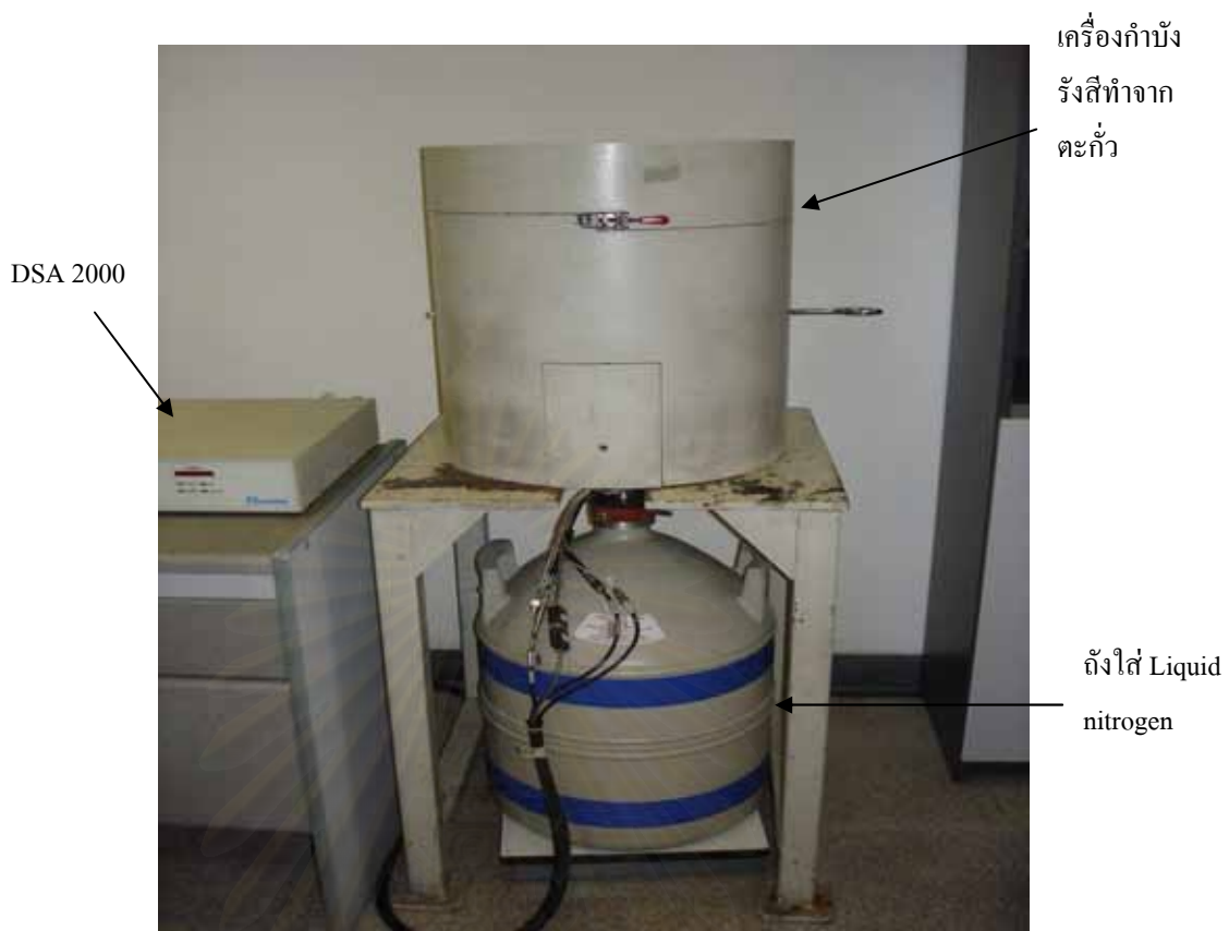
รูปที่ 3.1 หัววัดรังสีที่อยู่ภายในตะกั่วต่ออยู่กับถังบรรจุไนโตรเจนเหลว
