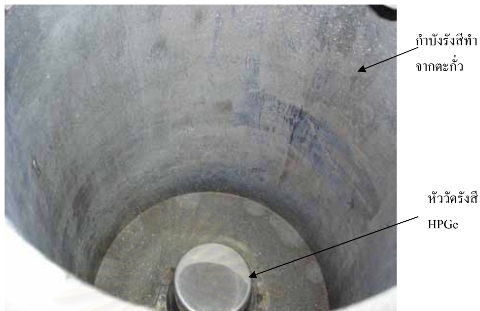
รูปที่ 3.3 หัววัดรังสี HPGe ในกำบังรังสีทำจากตะกั่ว
