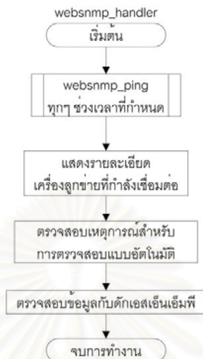
รูปที่ 4.20 ผังงานของฟังก์ชัน websnmp_handler
