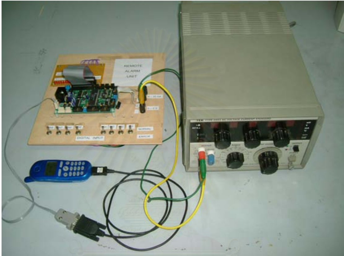
รูปที่ 7.8 ชุดทดสอบการทำงานของระบบแจ้งเตือนและสั่งการระยะไกล
