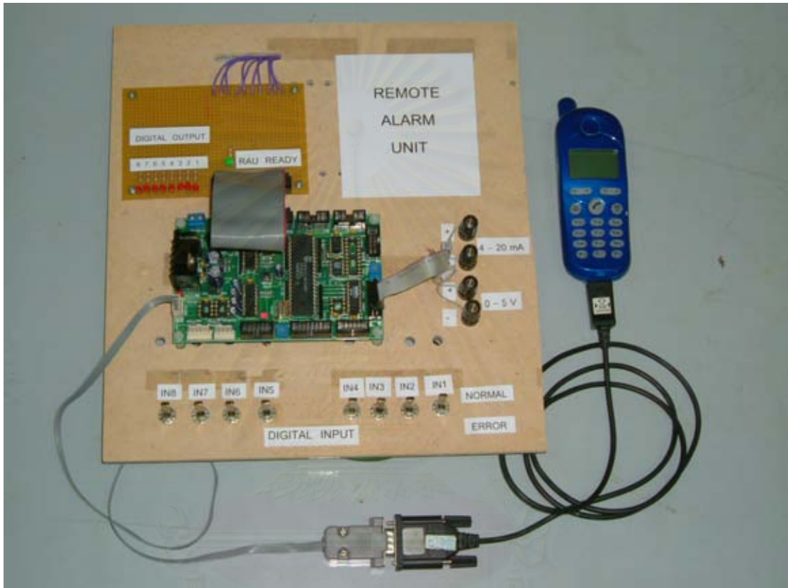
รูปที่ 7.9 แผงทดสอบระบบแจ้งเตือนและสั่งการทางไกล
