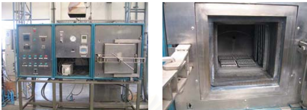
รูปที่ 4.2 ภาพแสดงเตาอบใช้สำหรับทำวัสดุซินเทอร์
