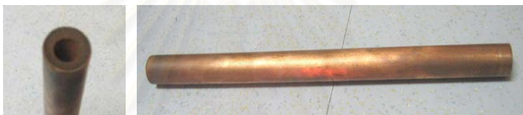
รูปที่ 4.3 ภาพแสดงท่อทองแดงที่ผงทองแดงภายในท่อผ่านการซินเทอร์แล้ว
