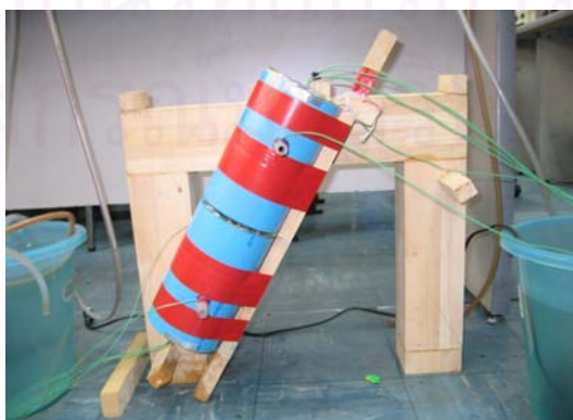
รูปที่ 4.15 การติดตั้งฮีตไปป์ที่มุม 60 องศา
