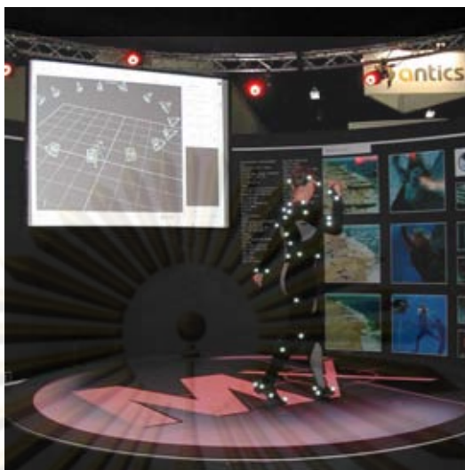
รูปที่ 2.26: ระบบ Motion Capture ที่ใช้มาร์คเกอร์อินฟราเรด
