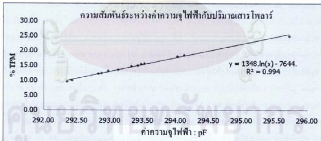
รูปที่ 4.4 ความสัมพันธ์ระหว่างค่าความจุไฟฟ้าและปริมาณสารโพลาร์ในน้ำมัน 13 ตัวอย่าง
