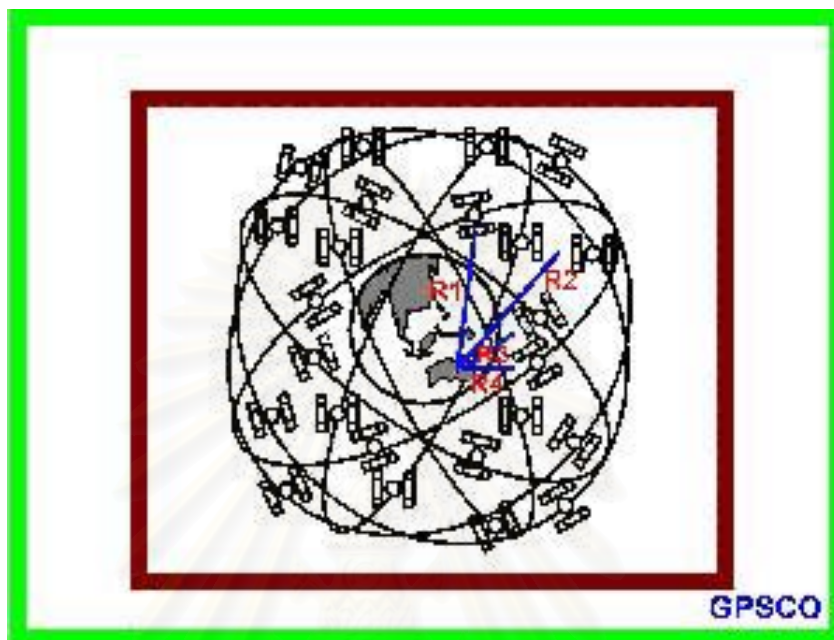
รูปที่ 2.1 แสดงวงโคจรดาวเทียมจีพีเอส (Rizos, 1997)
