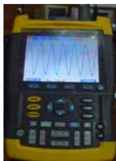
รูปที่ 5-2 เครื่องวัดคลื่นแรงดันไฟฟ้า Fluke 199C Scopemeter
