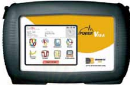
รูปที่ 5-3 เครื่องวัดคุณภาพไฟฟ้า Dranetz BMI Power Visa
