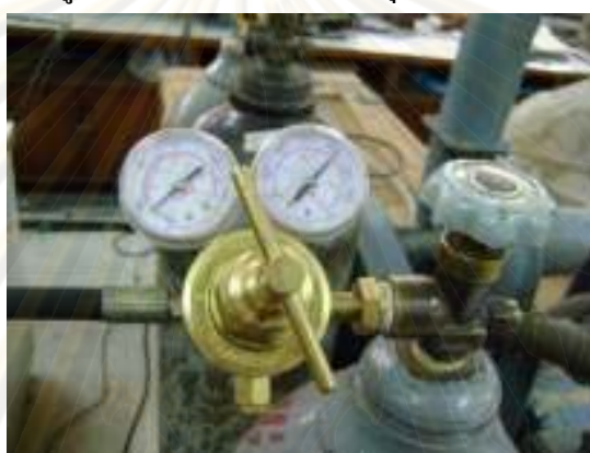
รูปที่ ข.8 -Pressure regulator Moris ปรับความดันจาก 0-3500 Psi เป็น 0-1000 Psi
