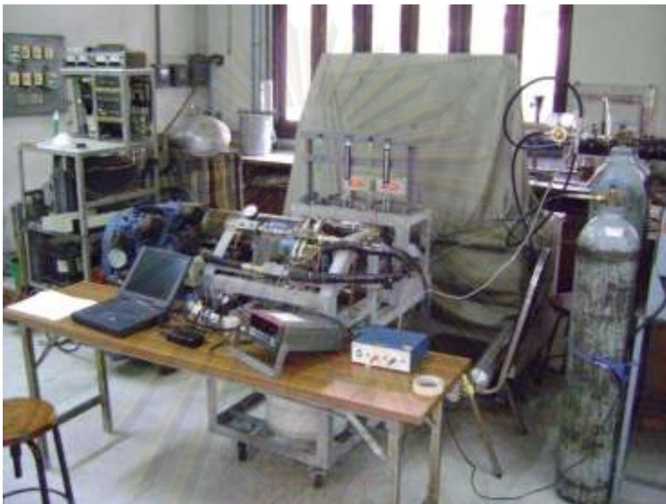
รูปที่ 5-27 อุปกรณ์ที่ใช้วัดและบันทึกค่าอุณหภูมิ, ความดัน
