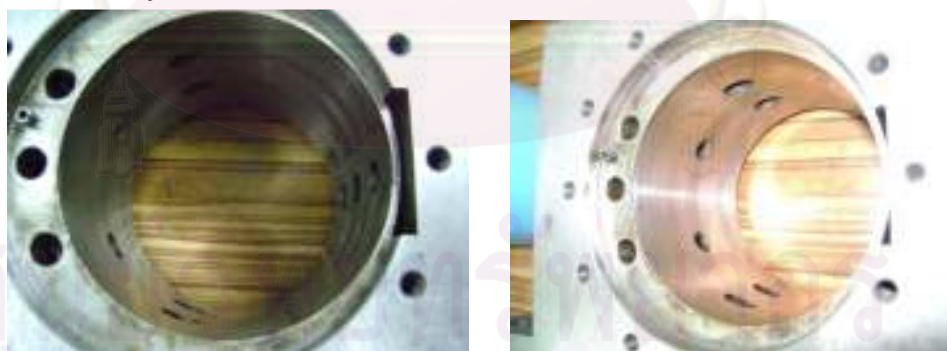
รูปที่ 5-11 การประกอบ Cylinder กับ Main case low pressure
