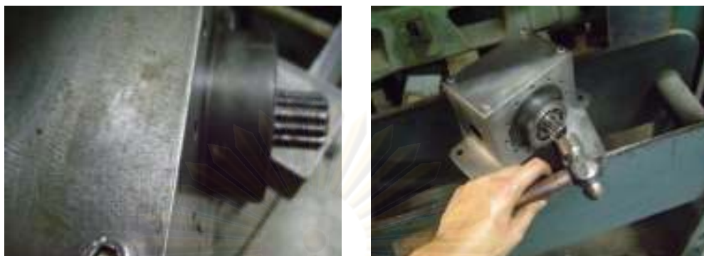
รูปที่ 5-16 การใส่ Front end plate และการปรับแต่งการหมุนของ Rotor
