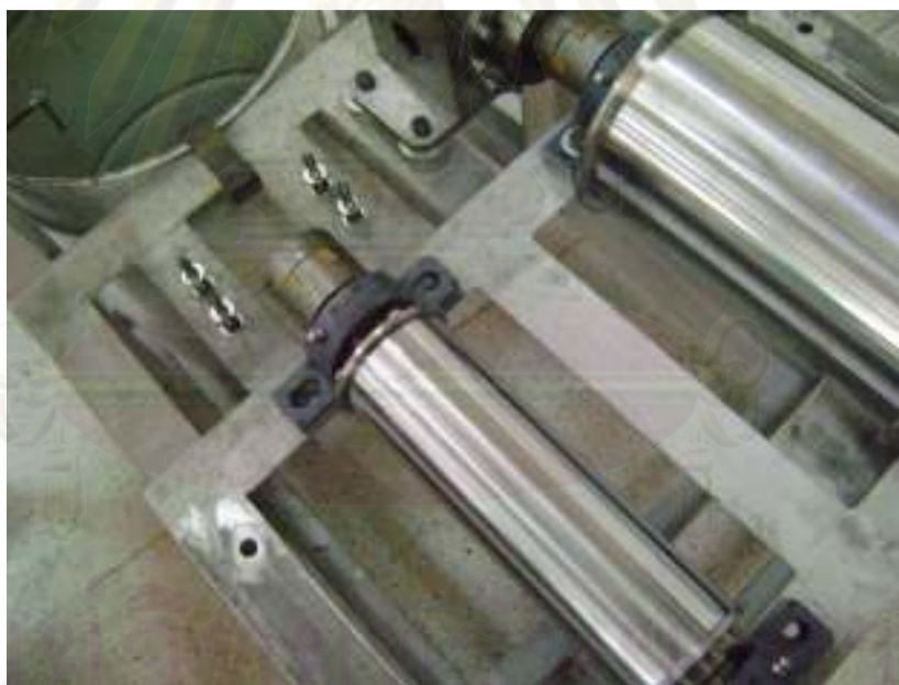
รูปที่ 5-21 ลักษณะการประกอบรอกเพื่อวัดแรงบิด
