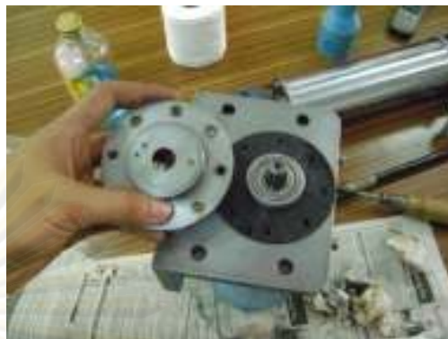
รูปที่ 5-6 การประกอบประกien และการวางฝา FBC1 กับ Main case high pressure
