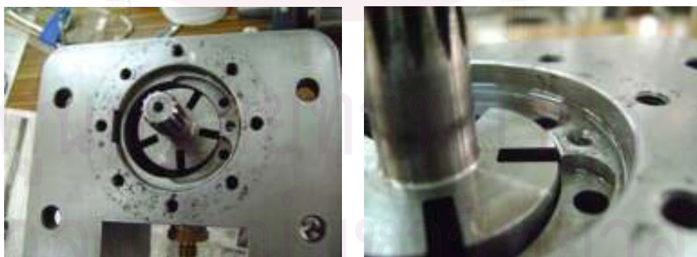
รูปที่ 5-3การประกอบชุดประกอบ Rotor กับชุดประกอบ Main case high pressure
