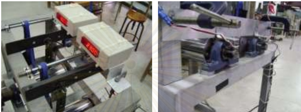
รูปที่ 5-22 ลักษณะการประกอบเครื่องวัดความเร็วรอบแบบดิจิตอลรุ่น MX 019
