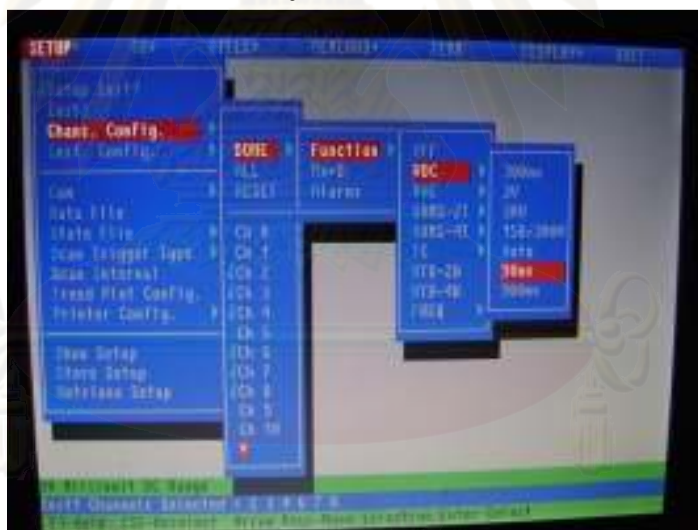
รูปที่ ข.12 เซตค่าประเภทอุปกรณ์วัดอุณหภูมิและเลือกช่องสัญญาณ เมื่อกำหนด ค่า Setup Inst 1แล้วจึงกำหนด Chans Config---Done-Function---TC---K หมายถึงการกำหนดค่าอุปกรณ์การวัดอุณหภูมิโดยสัญญาณมาจาก Thermo couple type K
