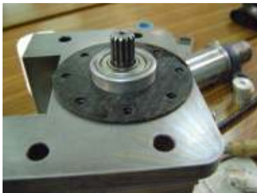
รูปที่ 5-6 การประกอบประกien และการวางฝา FBC1 กับ Main case high pressure
