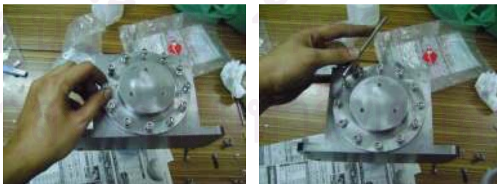
รูปที่ 5-18 การขันน็อตปิดฝา FBC2 และ BBC 2
