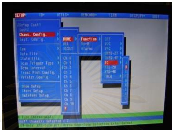
รูปที่ ข.12 เซตค่าประเภทอุปกรณ์วัดอุณหภูมิและเลือกช่องสัญญาณ เมื่อกำหนด ค่า Setup Inst 1แล้วจึงกำหนด Chans Config---Done-Function---TC---K หมายถึงการกำหนดค่าอุปกรณ์การวัดอุณหภูมิโดยสัญญาณมาจาก Thermo couple type K
