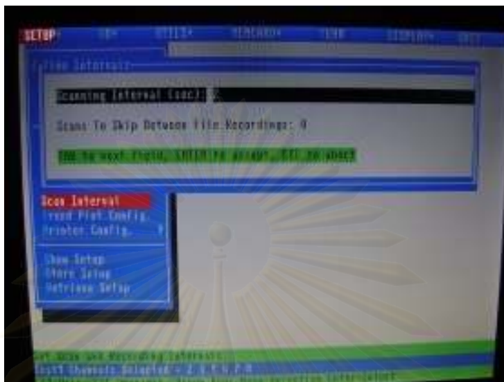
รูปที่ ข.15 เซตค่าช่วงเวลาการบันทึกสัญญาณทุกๆ 2วินาที
