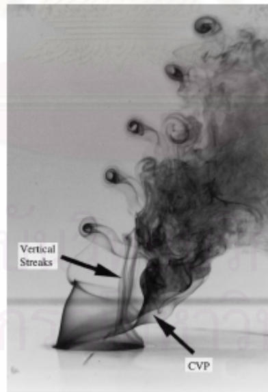
รูปที่ 1.5 ภาพ Flow pattern ที่ได้จากการใส่ Trace ที่บริเวณผนังเจ็ต (Lim et al. 2003)
