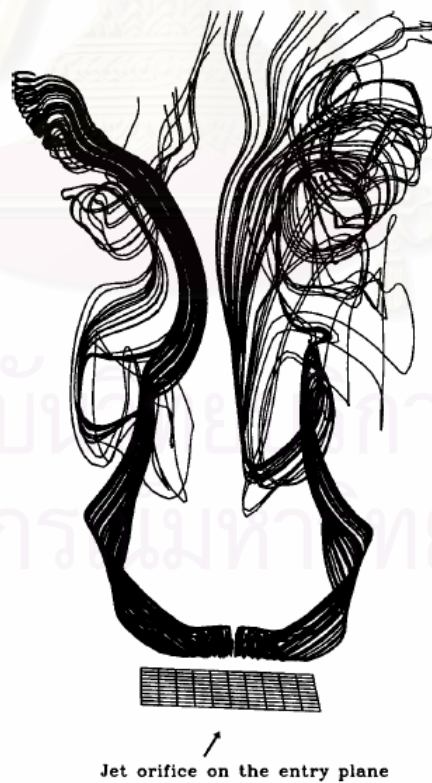
รูปที่ 1.19 วิวัฒนาการของ Streamlines ในการก่อตัวของ Kelvin – Helmholtz Vortex ที่ t = 21.0 , Re = 225 และ R = 2.5 (Sau et al. 2004)
