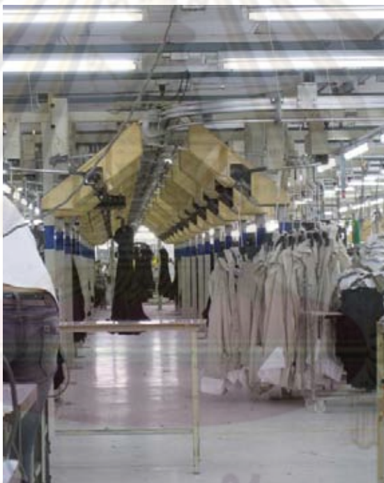
รูปที่ 3.9 Mover Hanger ของสายการผลิตเย็บประกอบ (สาขาลำพูน)
