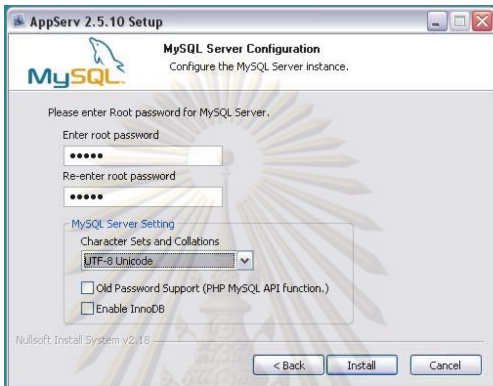
รูปที่ ค.7 แสดงการกำหนดค่าคอนฟิกของฐานข้อมูล MySQL
