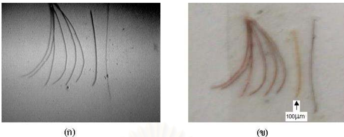
รูปที่ 4.17 แสดงภาพถ่ายรังสีเอกซ์ของเส้นลวดที่มีขนาดต่างๆ (20kV, 25 \mu A, 10sec และ 14 ^{\circ} C)
