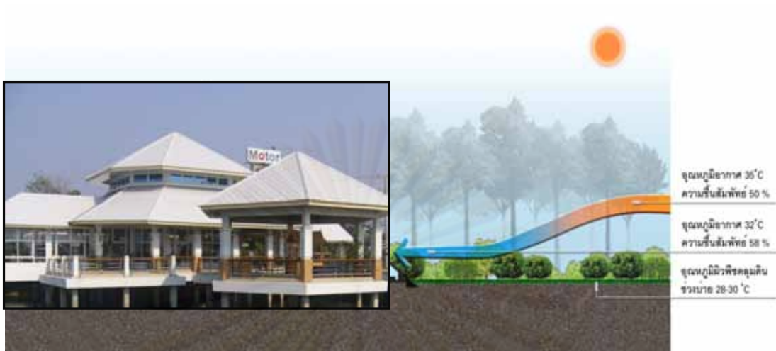
ภาพที่ 2-17 การใช้หญ้าหรือพืชคลุมดินเพื่อการปรับสภาพแวดล้อมรอบอาคาร
