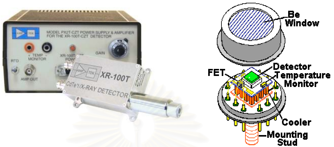
รูปที่ 3.1 หัววัดรังสีเอกซ์แบบกึ่งตัวนำชนิด CdTe (Cadmium Telluride)
