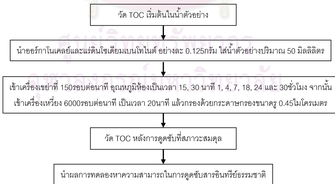
รูปที่ 3.6 ขั้นตอนการทดลองดูดซับสารอินทรีย์ธรรมชาติที่ระยะเวลาสัมผัสต่างๆ
