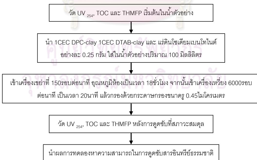
รูปที่ 3.5 ขั้นตอนการทดลองดูดซับสารอินทรีย์ธรรมชาติ
