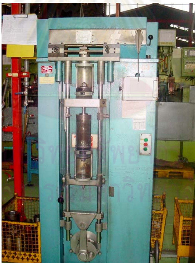
รูปที่ จ-1 ภาพเครื่องทดสอบ Koni Testing Machine, Model 4423-05
