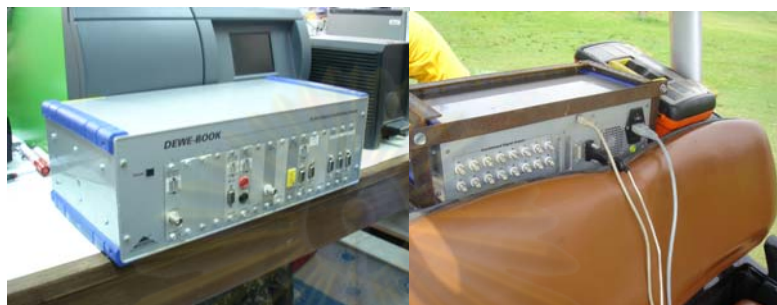
รูปที่ 9-3 Data Logger และตำแหน่งที่ติดตั้งในรถกอล์ฟ
