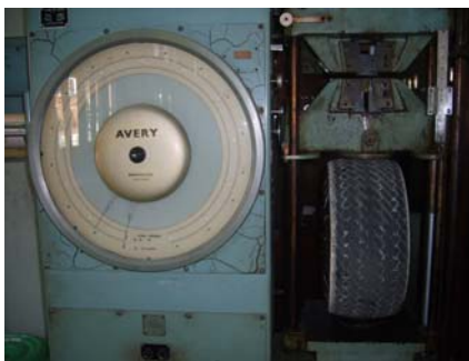
รูปที่ 4-2 การทดสอบหาค่าความแข็งสปริงของ ล้อและยาง
