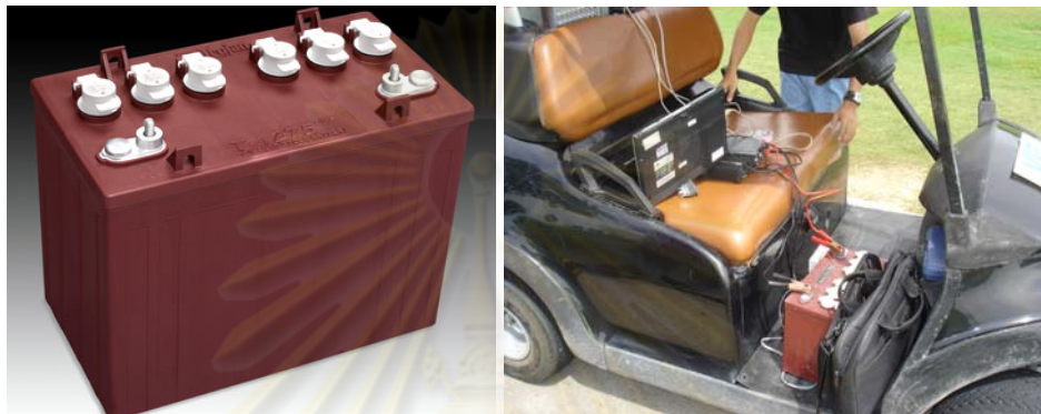
รูปที่ 6-10 แบตเตอรี่และตำแหน่งที่ติดตั้ง
