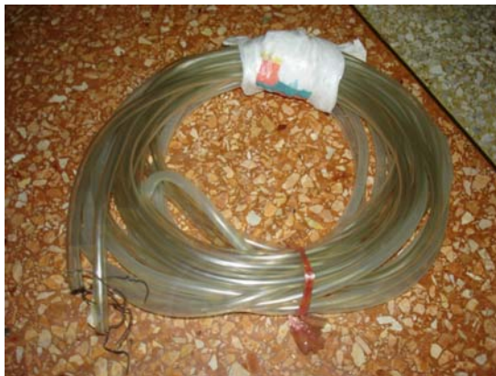
รูปที่ 6-15 ภาพสายยางสำหรับการตั้งระดับน้ำ
