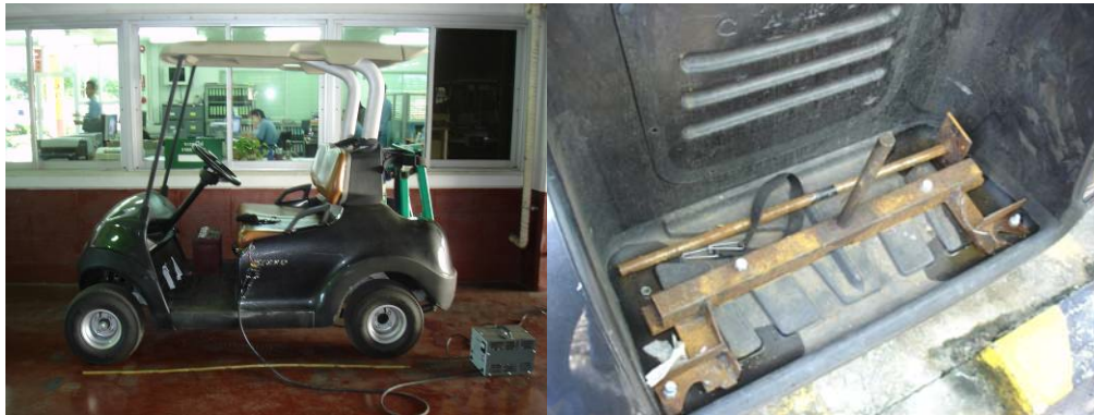
รูปที่ 6-2 ภาพรถกอล์ฟที่นำมาใช้ในการทำงานวิจัยครั้งนี้และชุดอุปกรณ์สำหรับลาก Rolling Straightedge ด้านหลังรถกอล์ฟ
