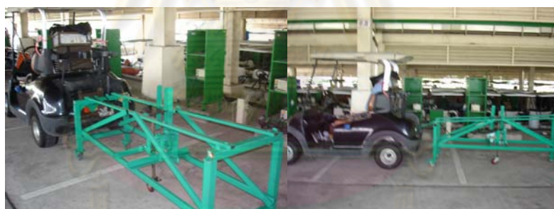
รูปที่ 6-5 Rolling Straightedge และการติดตั้งกับรถกอล์ฟ
