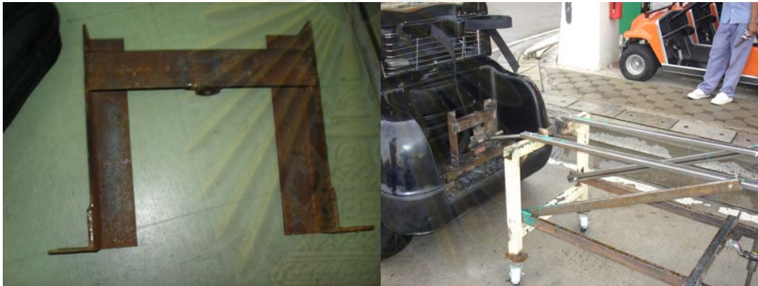
รูปที่ 6-3 อุปกรณ์ที่ทำสำหรับการยึด Rolling Straightedge กับ รถกอล์ฟ
