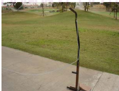
รูปที่ 6-14 ภาพเสาดั่งสำหรับการตั้งจุดอ้างอิงในการวัดระดับน้ำ
