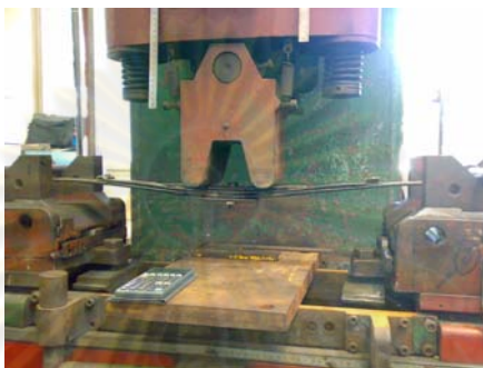
รูปที่ 4-3 การทดสอบหาค่าความแข็งแรงสปริงของແໜบ
