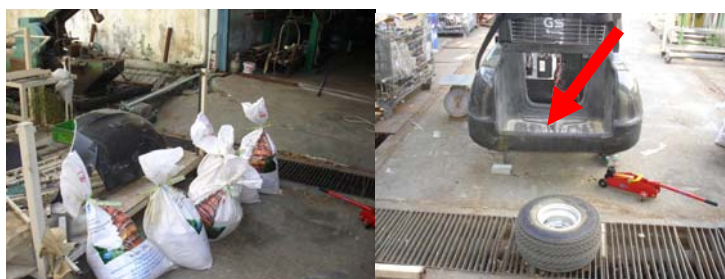
รูปที่ 4-9 ถุงทรายที่ใช้ในการกระตุ้นทำให้เกิดการสั่นแบบอิสระ (ซ้าย)
