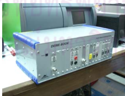
รูปที่ 4-8 ภาพแสดง Data Logger และตำแหน่งที่ติดตั้งในรถกอล์ฟ
