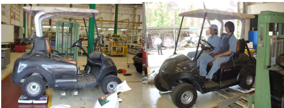
รูปที่ 4-5 การชั่งมวลรถกอล์ฟเพื่อหาค่ามวลส่วนสปริงรองรับ
