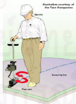
รูปที่ ก-3 การใช้งานของเครื่องมือ Dipstick
