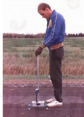
รูปที่ ก-3 การใช้งานของเครื่องมือ Dipstick
