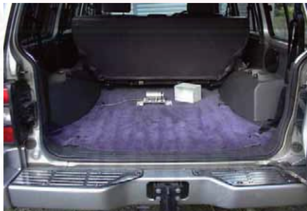
รูปที่ ก-5 การติดตั้ง Bump Integrator
