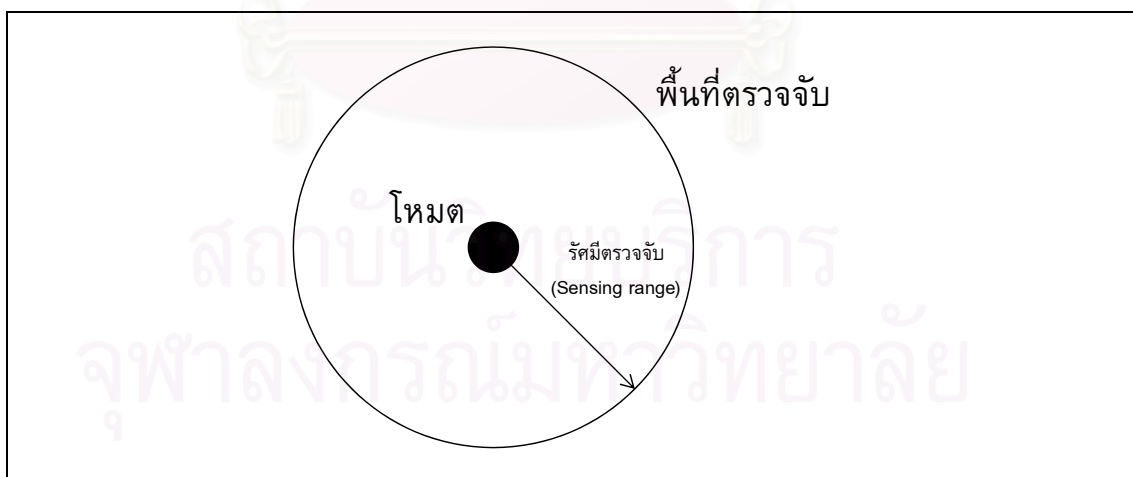
รูปที่ 2.1 แบบจำลองตำแหน่งและพื้นที่ตรวจจับของโหนด
