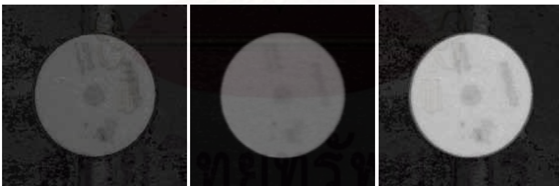
รูปที่ 37 แสดงผลลัพธ์กระบวนการแยกแชนเนลสี (จากซ้ายไปขวา) (ก) ผลลัพธ์ของ AND Operation ระหว่างแชนเนลสีแดงและสีน้ำเงิน, (ข) ผลลัพธ์เมื่อนำแชนเนลสีแดงลบด้วยแชนเนลสีน้ำเงิน และ (ค) ผลลัพธ์ของภาพ (ก) บวกกับภาพ (ข)
