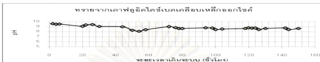
รูปที่ 4.27 ความสัมพันธ์ระหว่างระยะเวลาในการเดินระบบกับค่าพีเอชของสารละลายแคดเมียมไฮดรอกไซด์ (II) ที่ออกจากระบบที่ความสูงของตัวกลางดูดซับที่ 90 เซนติเมตร
