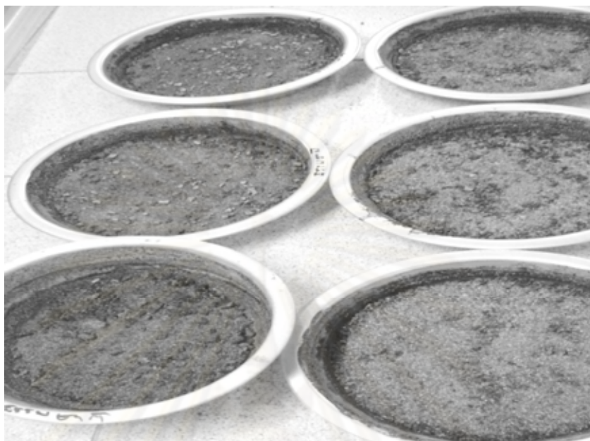
ภาชนะสำหรับเตรียมตัวกลางดูดซับ เส้นผ่านศูนย์กลาง 6 นิ้ว
