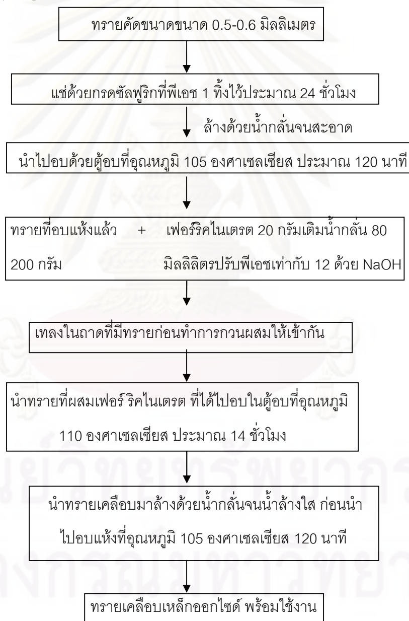
รูปที่ 3.1 ขั้นตอนการเตรียมทรายเคลือบเหล็กออกไซด์
