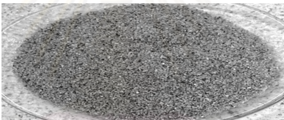
รูปที่ 4.5 ทรายจากเตาฟลูอิดไดซ์เบดเคลือบเหล็กออกไซด์
