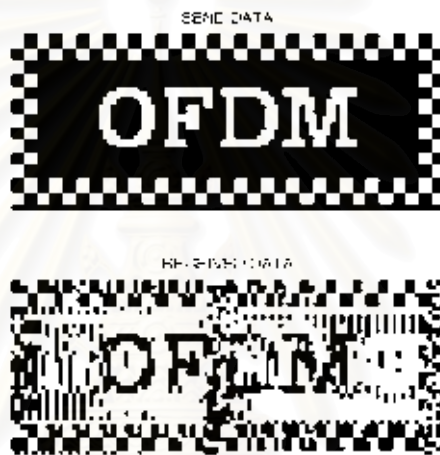
รูปที่ 5-19 ข้อมูลซึ่งรับได้จากการทดสอบขณะมีสัญญาณรบกวนในสายส่ง
