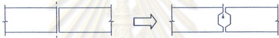
รูปภาพที่ 2.39 แสดงลักษณะของชิ้นส่วนผนังสำเร็จรูปที่มีส่วนเว้าเพื่อกันการไหลย้อนของน้ำ
