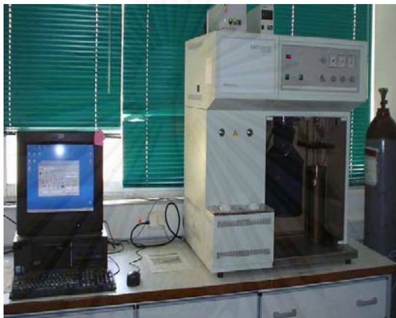
รูปที่ 3.7 เครื่องหาพื้นที่ผิวรูพรุนทั้งหมด(BET surface area)
