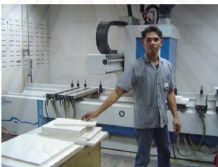
รูปที่ 5.12 วางชิ้นงานบนโต๊ะและหยิบชิ้นงานเข้าเครื่องเจาะ/เซาะร่องหลังปรับปรุง
