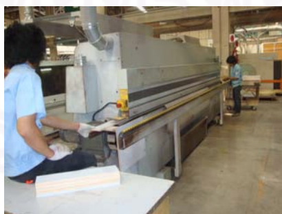
รูปที่ 5.5 เครื่องปิดขอบและการทำงานก่อนปรับปรุงสร้างสายพาน
