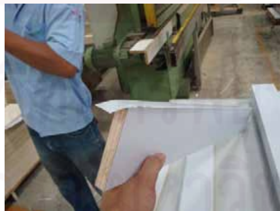
รูปที่ 4.6 ขอบแผ่น PVC ไม่เสมอขอบไม้
