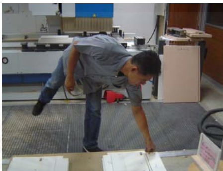
รูปที่ 5.11 วางชิ้นงานกับพื้นและก้มตัวหยิบชิ้นงานเข้าเครื่องเจาะ/เซาะร่องก่อนปรับปรุง
