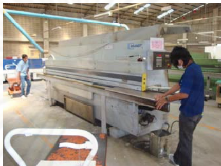
รูปที่ 3.4 ภาพกระบวนการปิดขอบและเครื่องปิดขอบ
