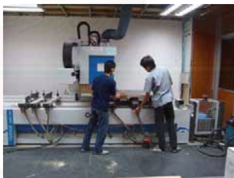
รูปที่ 3.5 ภาพกระบวนการเจาะ/เซาะร่องและเครื่องเจาะ/เซาะร่อง
