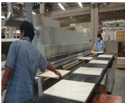
รูปที่ 5.6 สายพานลำเลียงชิ้นส่วนงานปิดขอบจากท้ายไปหัวเครื่อง
