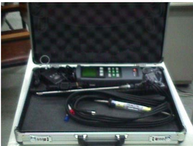
รูปที่ 6.2 อุปกรณ์วิเคราะห์ส่วนประกอบของไอเสีย
