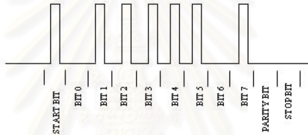
รูปที่ 2.22 การส่งข้อมูลเป็นรหัส ASCII 'A' แบบ IrDA ของปาล์ม
