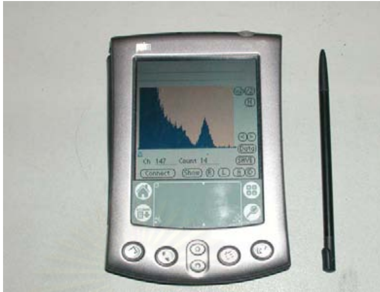
รูปที่ 4.19 แสดงสเปกตรัมพลังงานรังสีแกมมาของ Cs-137
