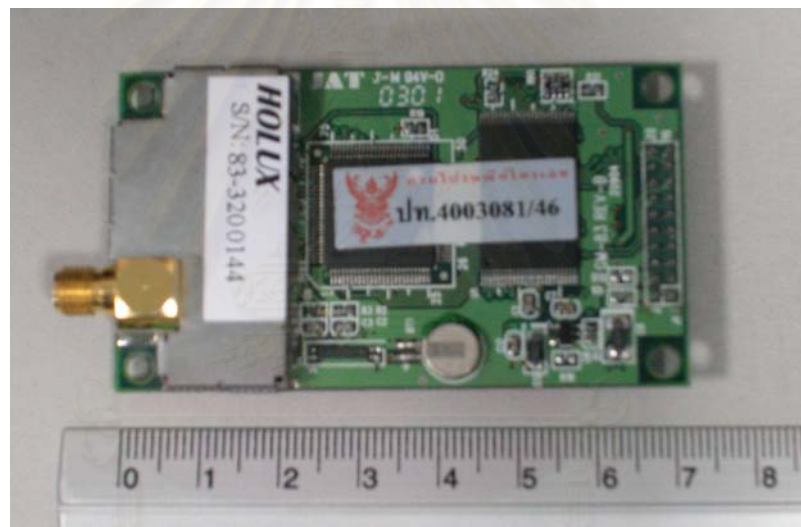
รูปที่ 3.14 โมดูลของ HOLUX รุ่น GM-83
