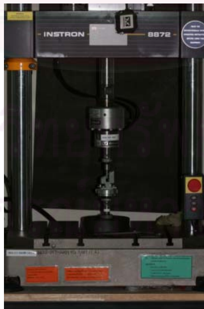
รูปที่ 21 แสดงการยึดชิ้นงานและอุปกรณ์ยึดชิ้นงานเข้ากับเครื่องทดสอบสากล
