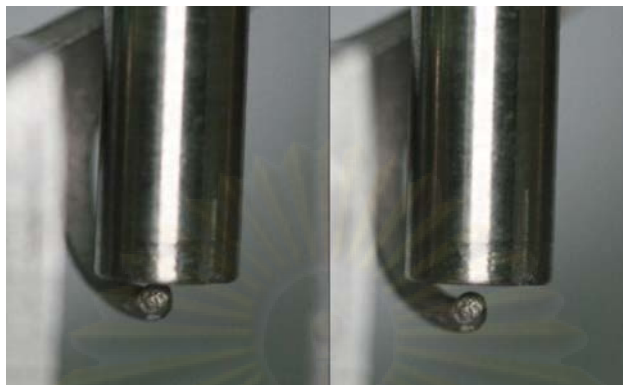
รูปที่ 29 ภาพขยายส่วนปลายตะขอของชิ้นงานและหัวกด ภาพซ้ายแสดงชิ้นงานก่อนการทดสอบความล้าเบี่ยงเบน ภาพขวาแสดงชิ้นงานหลังการทดสอบความล้าเบี่ยงเบน
