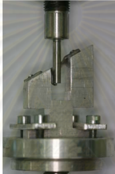
รูปที่ 20 แสดงการยึดชิ้นงานเข้ากับอุปกรณ์ยึดชิ้นงาน
