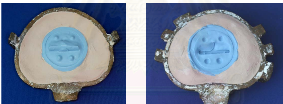
รูปที่ 12 แสดงเบ้าอัดขึ้นงานตัวอย่างฝาบบนและฝาล่าง
