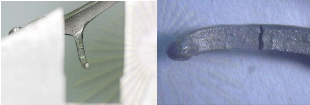
รูปที่ 22 ภาพตะขอหักหลังจากการทดสอบเบนด์
