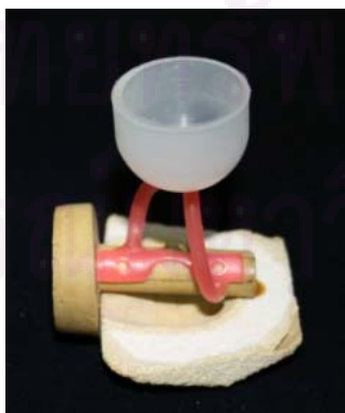
รูปที่ 4 แสดงการยึดจี๊ดึงแกนค้ำรูเทเข้ากับแบบจี๊ดึงขึ้นตัวอย่างต้นแบบ
