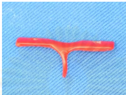
รูปที่ 13 ชิ้นตัวอย่างอะคริลิกเรซินสำหรับเหวี่ยงโลหะ
