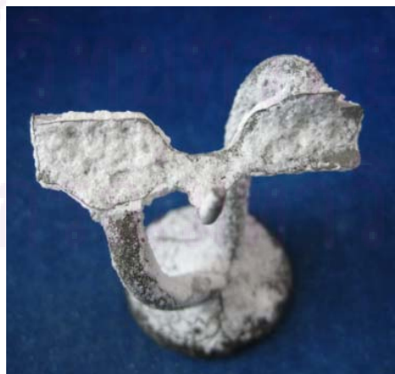
รูปที่ 9 แสดงชิ้นตัวอย่างโลหะหลังแยกวัสดุหล่อเข้าออก
