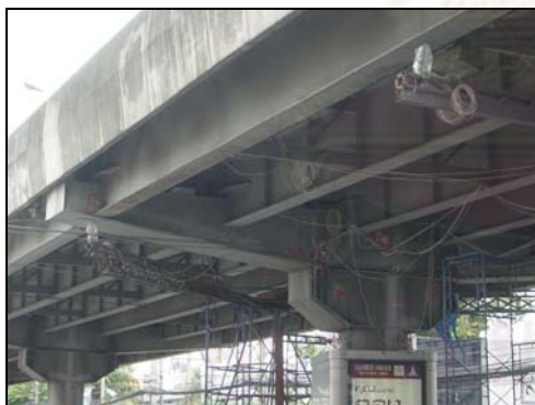
รูปที่ 5.6 แสดงการติดตั้งอุปกรณ์ตรวจจับสัญญาณที่สะพานทดสอบจริงในสนาม
