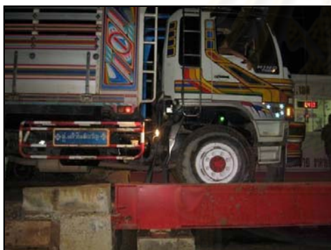
รูปที่ 5.9 ภาพแสดงการชั่งน้ำหนัก รถบรรทุกที่ด้านชั่งน้ำหนักก่อนการทดสอบ
