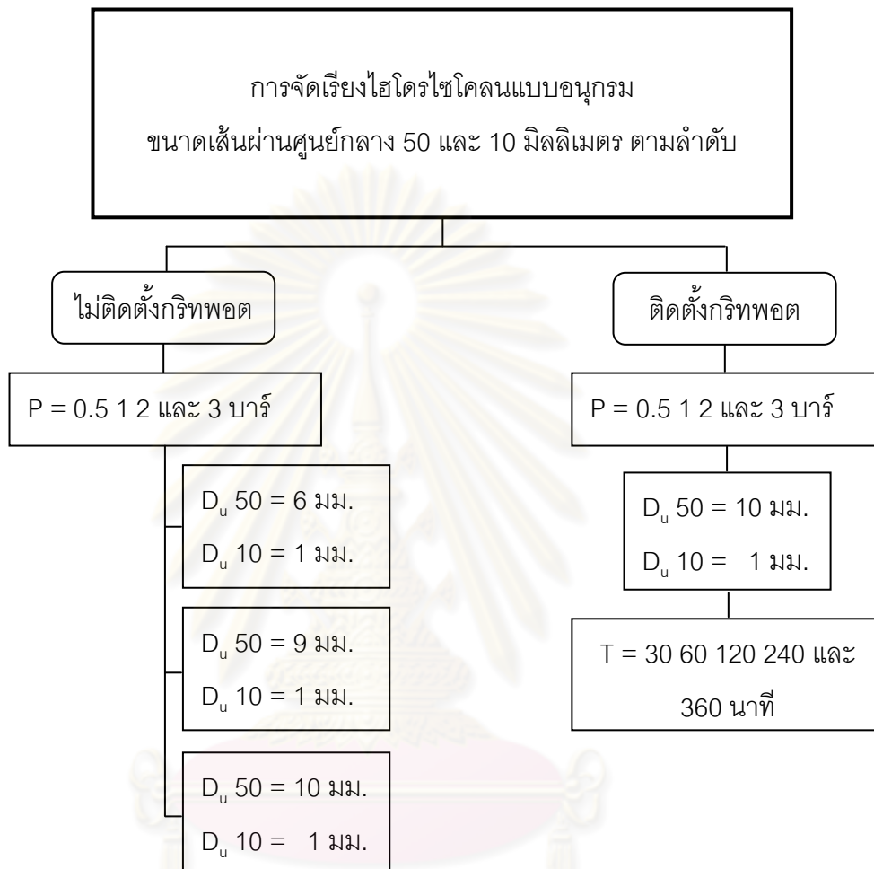
รูปที่ 3.10 แผนผังการทดลองด้วยการจัดเรียงไฮโดรไซโคลนแบบอนุกรมขนาดเส้นผ่านศูนย์กลาง 50 และ 10 มิลลิเมตร ตามลำดับ ที่ไม่ได้ติดตั้งและที่ติดตั้งกริทพอด
