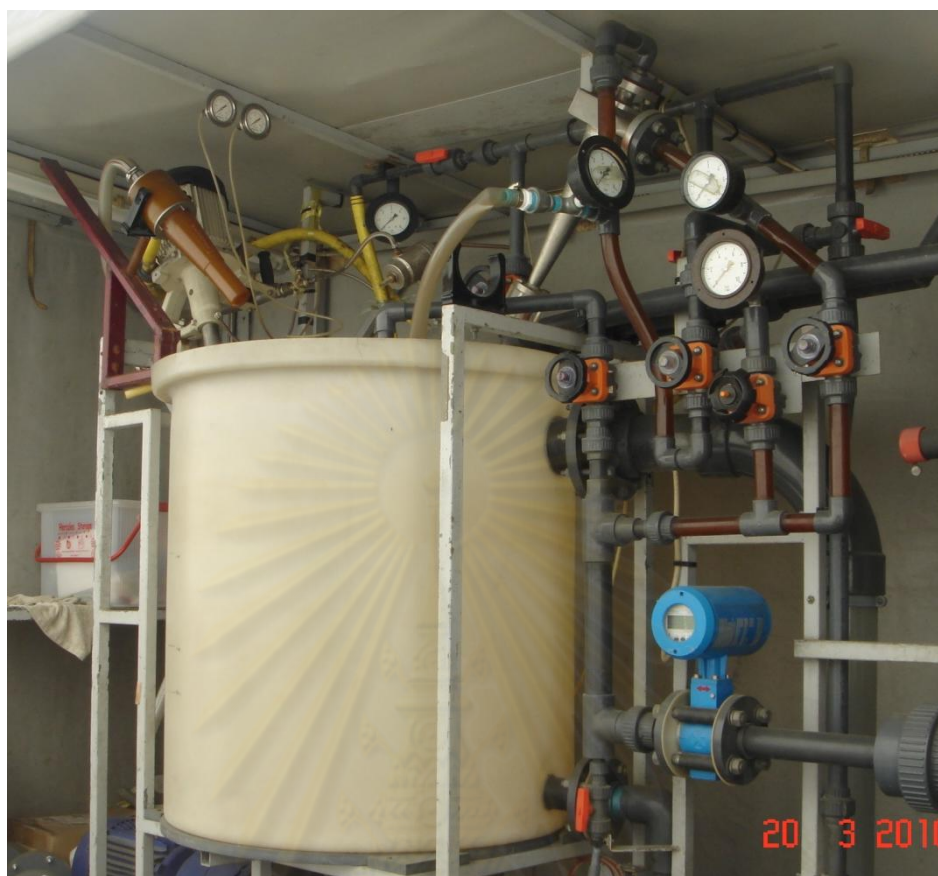
รูปที่ 3.6 Pilot plant ที่ใช้ทำการทดลองในสถานที่จริง และไฮโดรไซโคลนที่ต่อกันแบบอนุกรม (แสดงการต่ออนุกรมของไฮโดรไซโคลนแบบอนุกรมขนาด 75 50 และ 10 มิลลิเมตร)
