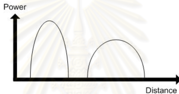
รูปที่ 2.3 ผลของดิสเพอร์ชันต่อสัญญาณที่เดินทางในเส้นใยแสง
