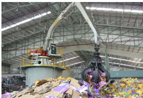
ภาพที่ 3.2 กระบวนการเตรียมเชื้อเพลิงทดแทนที่เป็นของแข็ง
