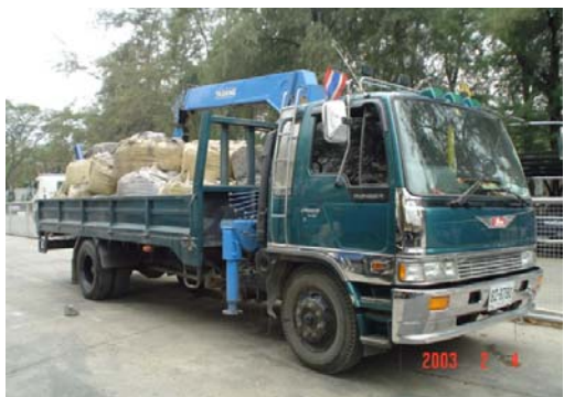
รถบรรทุกเครนเคลื่อนที่ (Mobile Crane)
