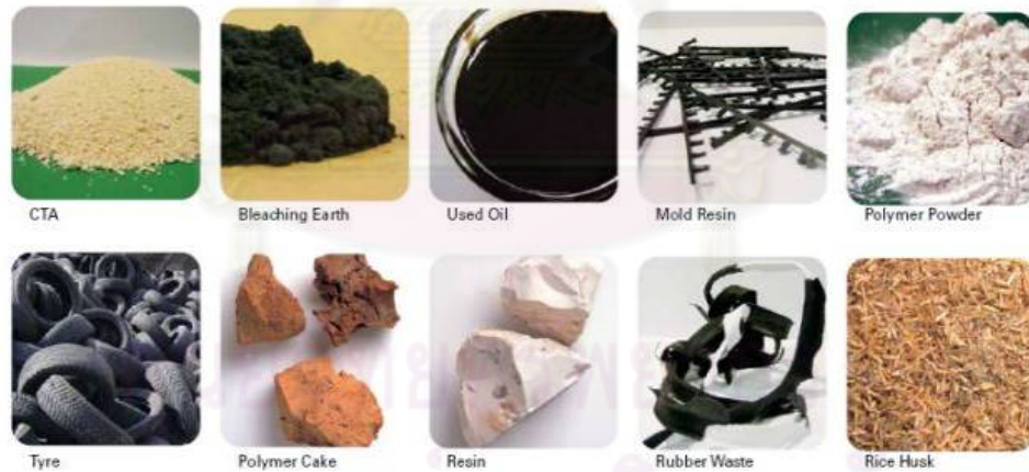
ภาพที่ 3.1 วัสดุที่ไม่ใช้แล้วที่สามารถกำจัดด้วยวิธีการเผาในเตาเผาปูนซีเมนต์ได้
