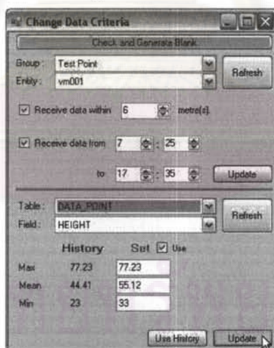
รูปที่ 5.57 รูปแสดงการแก้ไขเงื่อนไขรับข้อมูลเป็นช่วงตัวเลข
