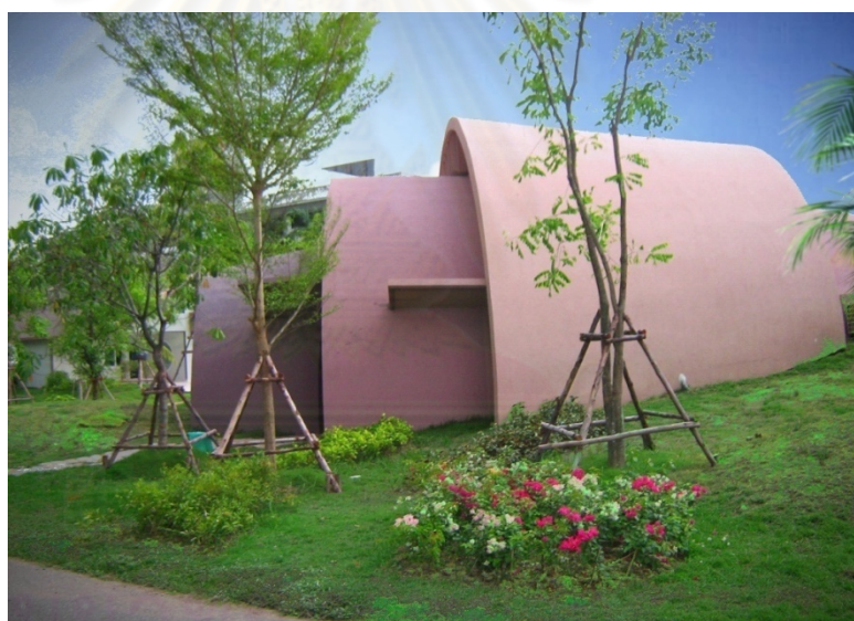
ภาพที่ 5-19 สภาพแวดล้อมบริเวณด้านข้างห้องเรียนธรรมชาติหลังปรับปรุงทัศน โดยใช้ต้นไม้ใหญ่สกัดกั้นการแผ่รังสีความร้อนจากดวงอาทิตย์และใช้ประโยชน์จากพืชคลุมดินดูดซับน้ำใต้ดินขึ้นมาระเหยงทำให้อุณหภูมิอากาศบริเวณห้องเรียนธรรมชาติเย็นลง ใช้ประโยชน์จากดอกไม้และปรับปรุงบริเวณทางเข้า และสร้างเนินดินเพื่อให้มีทัศนียภาพที่สวยงามทำให้คนเกิดแรงกระตุ้นและออกกำลังกายเพิ่มขึ้น
