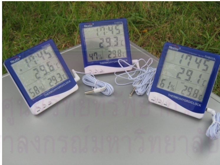
ภาพที่ 3-7 แสดงเครื่องมือที่ใช้วัดอุณหภูมิอากาศ อุณหภูมิดินลึก 1 เมตร อุณหภูมิน้ำลึก 1 เมตร และความชื้นสัมพัทธ์ บริเวณมหาวิทยาลัยราชภัฏราชนครินทร์ วิทยาเขตบางคล้า เก็บข้อมูล วันที่ 12 เมษายน 2553 เวลา 21.00 น. ถึง วันที่ 14 เมษายน 2553 เวลา 09.00 น.
