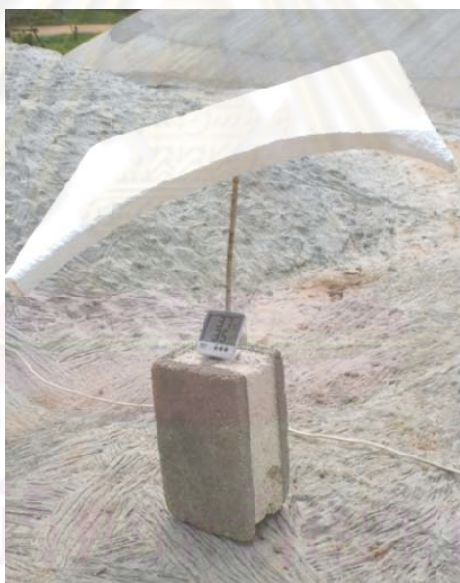
ภาพที่ 3-1 แสดงเครื่องมือที่ใช้วัดอุณหภูมิอากาศและความชื้นสัมพัทธ์ภายนอกอาคาร บริเวณดีเอ็นเอ รีแอนด์สปา วันที่ 19 กุมภาพันธ์ 2553
