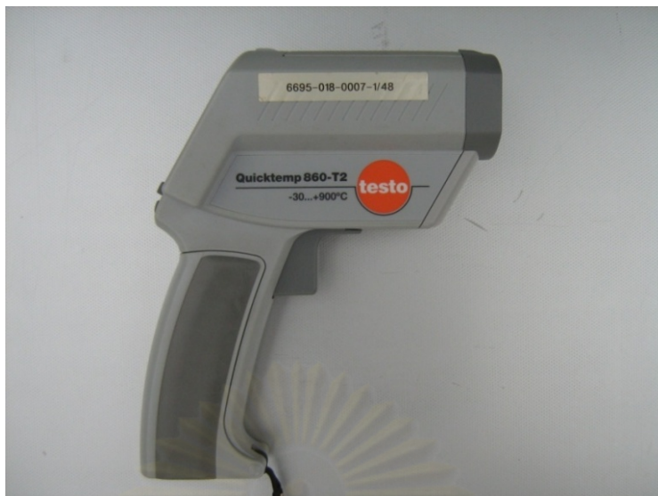
ภาพที่ 3-6 แสดงเครื่องมือที่ใช้วัดอุณหภูมิผิวน้ำ อุณหภูมิผิวหน้ากลางแจ้ง อุณหภูมิผิวน้ำในร่ม อุณหภูมิผิวดิน อุณหภูมิต้นไม้สูง อุณหภูมิของท้องฟ้า บริเวณมหาวิทยาลัยราชภัฏราชนครินทร์ วิทยาเขตบางคล้า เก็บข้อมูล วันที่ 12 เมษายน 2553 เวลา 21.00 น. ถึง วันที่ 14 เมษายน 2553 เวลา 09.00 น.
