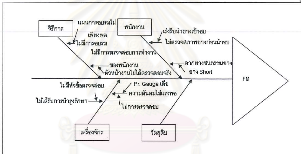
รูปที่ 3.26 แสดงแผนภาพก้างปลาเพื่อวิเคราะห์หาสาเหตุของปัญหา FM
