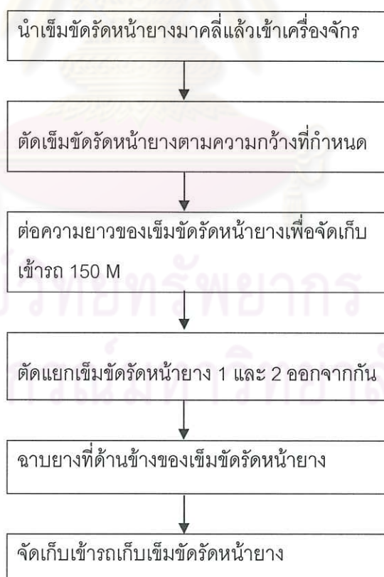
รูปที่ 3.10 ขั้นตอนการตัด STEEL BELT
