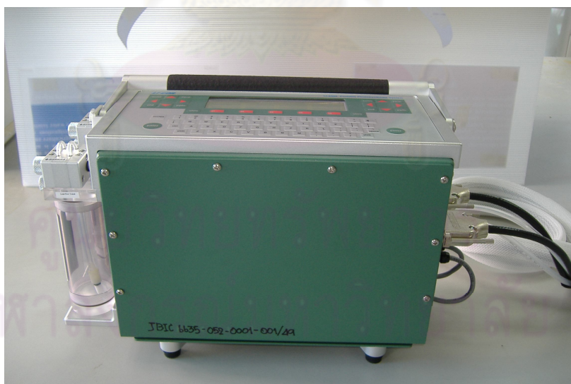
ภาพที่ 3.4 เครื่องวัดปริมาณก๊าซคาร์บอนไดออกไซด์ (carbondioxy analyzer) ยี่ห้อ LI-COR รุ่น LI-6400
