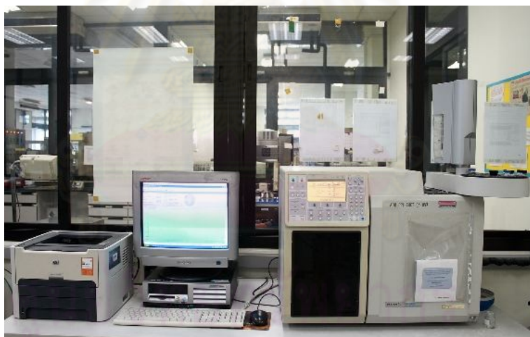
รูปที่ 3.5 เครื่องแก๊สโครมาโทกราฟ (Gas chromatograph) รุ่น CP-3800 ของ Varian
