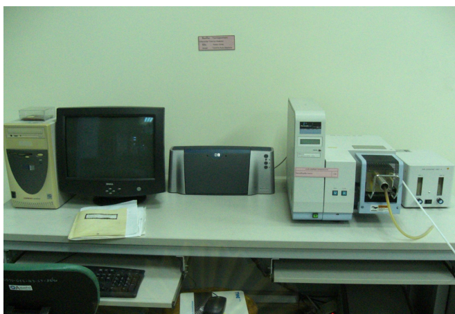
รูปที่ 3.2 เครื่อง Thermal analyzer รุ่น Pyris Diamond ของ PerkinElmer
