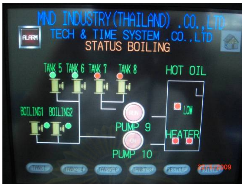
รูปที่ 14 หน้าตรวจสถานะการทำงานถังต้มน้ำมันร้อน
