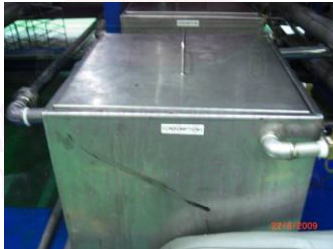
รูปที่ 30 ถังเก็บน้ำยาถังที่หนึ่ง
