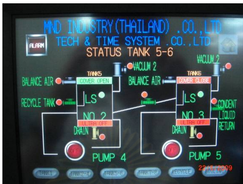
รูปที่ 12 หน้าตรวจสภาวะการทำงานถังที่ 5-6
