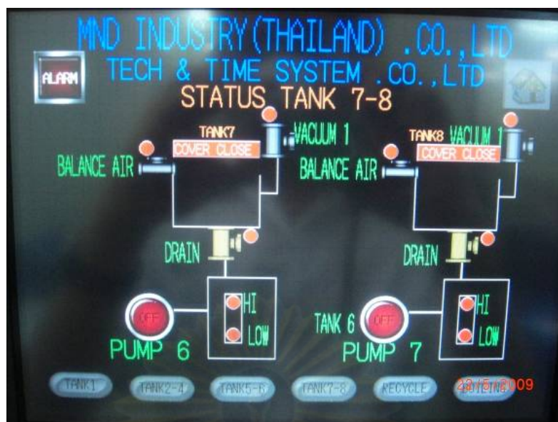
รูปที่ 13 หน้าตรวจสภาวะการทำงานถังที่ 7-8
