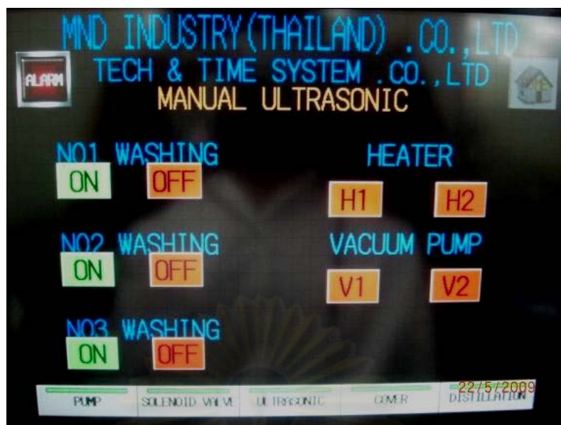
รูปที่ 17 หน้าจอควบคุมอัลตราโซนิกด้วยตนเอง
