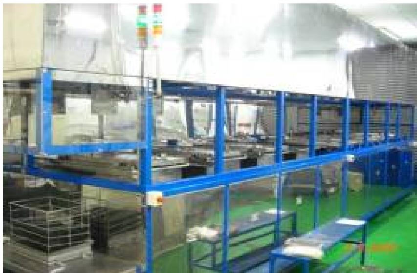
ภาพที่ 1.4 เครื่องล้างไฮโดรคาร์บอนแบบอัตโนมัติ
