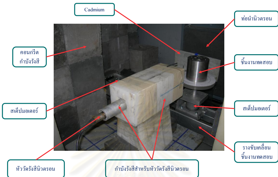
รูปที่ 2 แผนภาพการติดตั้งอุปกรณ์ภายในบริเวณกำบังรังสี
