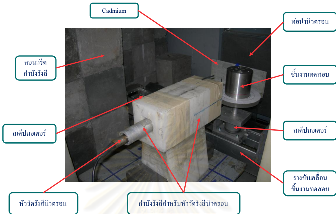
รูปที่ 3.16 แผนภาพการติดตั้งอุปกรณ์ภายในบริเวณกำบังรังสี
