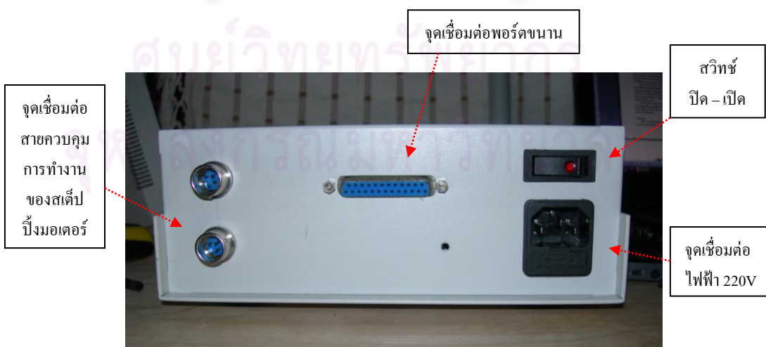
รูป 3.13 ด้านหลังชุดควบคุมการขับเคลื่อนชิ้นงานทดสอบพร้อมแสดงตำแหน่งการเชื่อมต่อ
