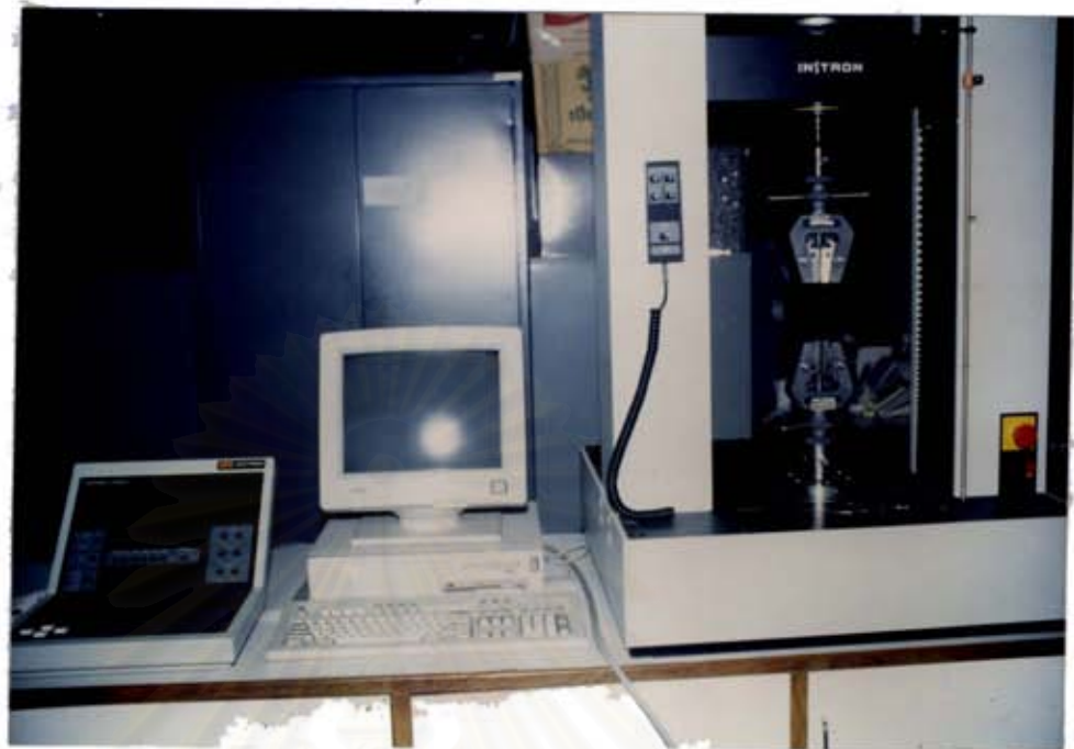
รูปที่ 29 เครื่องมือทดสอบทั่วไป Instron universal testing machine รุ่น 4500
